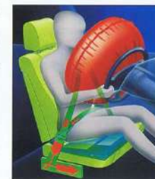
Klassenlose Sicherheit: Der bei allen BMW serienmäßige Fahrer-Airbag bietet zusammen mit dem angelegten Sicherheitsgurt mit Gurt-schloßstrammer und der Submarining-Stütze optimalen Schutz bei einem Frontalaufprall. Innerhalb von Hundertstelsekunden füllt sich der Luftsack und fängt Kopf und Oberkörper auf.
