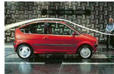
Non seulement la propulsion, mais aussi toute la conception de la E1 est systématiquement axée sur la compatibilité avec l'environnement. La carrosserie, l'enveloppe par exemple, est réalisée dans des matériaux en grande partie recyclables.
