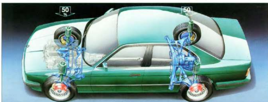
Het onderstel: grote spoorbreedte, lange wielbasis en optimale gewichtsverdeling, voor maximale stabiliteit, verminderde reacties op wisselingen in het aandrijfkoppel en uitstekende winter eigenschappen.
