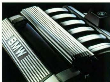
De BMW 520i en 525i/ix worden aangedreven door 6-cilinder motoren met 4 kleppen per cilinder. De ingenieurs van BMW hebben hier het superieure concept van een 6-cilinder in lijn gecombineerd met de allernieuwste 4-kleppentechniek. Het resultaat: toegenomen efficiency, de gecultiveerde loopkarakteristiek en lagere emissiewaarden.
