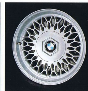
Leichtmetallräder mit Notlaufeigenschaften verhindern im Falle eines plötzlichen Defekts, daß sich der Reifen von der Felge löst. Das Fahrzeug bleibt so leichter beherrschbar.
