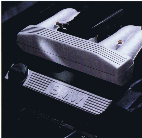
Richtungweisend. Der Vierzylinder im 318i Cabrio ist in dieser Klasse ein Vorbild an Laufruhe, Effizienz und Dynamik. Aus 1,8 Liter Hubraum entwickelt er 83 kW/113 PS bei 5500/min und 162 Nm bei 4250/min.
