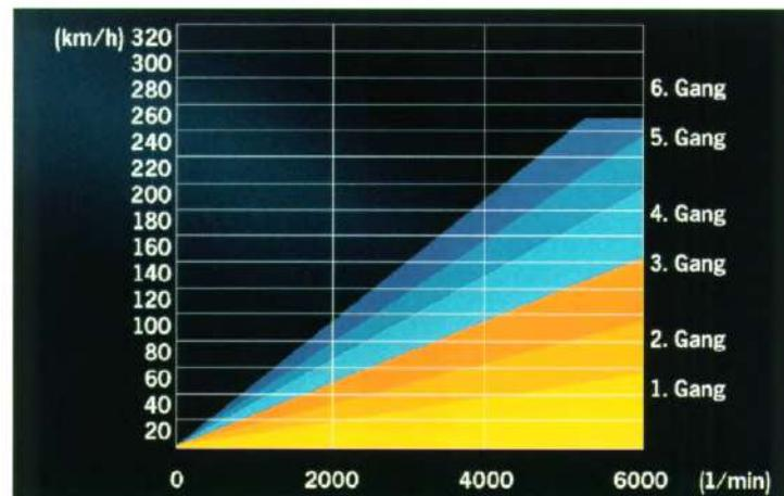
wird im 6. Gang erreicht. Das Schaltprinzip ist eine logische Erweiterung des 5-Gang-Schemas. Die tech-nisch konsequente Lösung mit neuartiger Verzah-nungsauslegung und verschleißfesten Synchronringen bietet den Komfortvorteil eines sehr geringen Ge-räuschniveaus. Dazu trägt wesentlich auch eine kon-struktiv neue Getriebelagerung bei, die durch ein hydraulisch gedämpftes Hydrolager für eine akusti-sche Entkoppelung sorgt.
