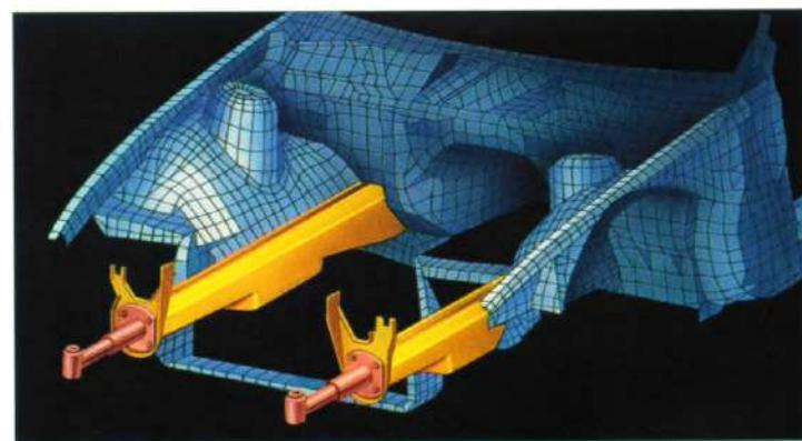
geschlossen. Die Stoßflächen sind stilistisch in die Fahrzeugkontur integriert. Bei einem Aufprall bis zu 15 km/h absorbieren Faltrohre vorn und hinten die Energie: ein wesentlicher Vorteil, denn das Faltrohr-System ist einfach und kostengünstig auszutauschen.
