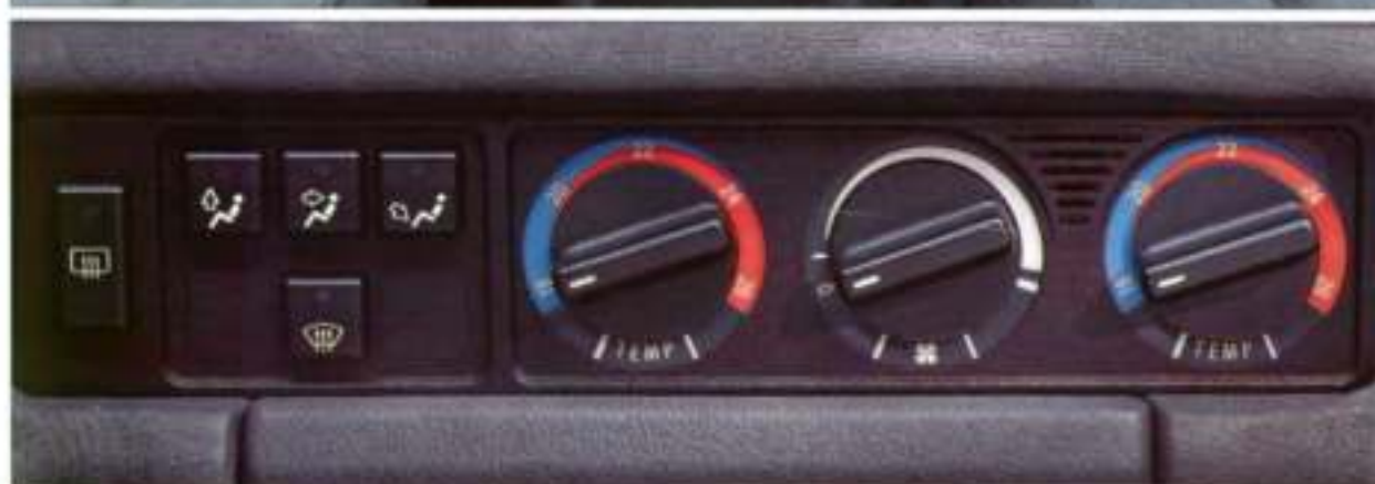
Klimaatbeheersing. Elektronisch geregelde verwarming/ventilatie; individueel voor bestuurder en voorpassagier regelbaar. Grote, traploos regelbare geruisarme aanjager.
