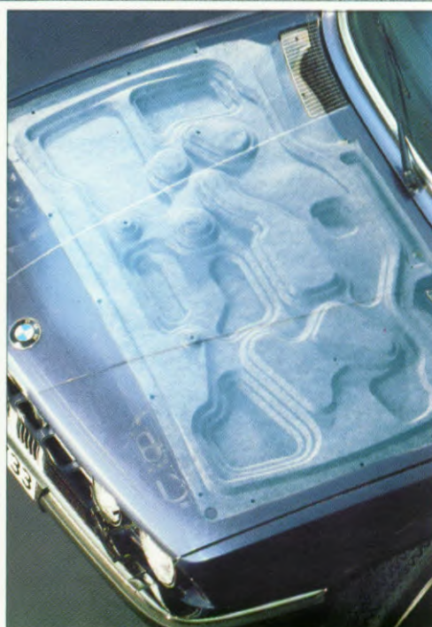
De motorkap van een BMW-diesel is bekleed met geluids- isolerend materiaal in reliëfvorm.
