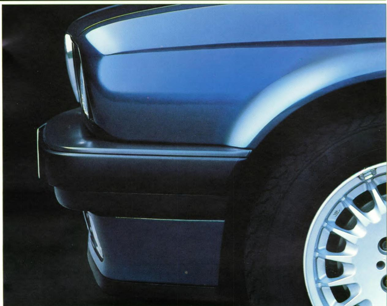
**Höchste Sicherheit.** Aufwendig berechnete Knautschzonen halten die Aufprallenergie bei einem Frontalzusammenstoß mit bis zu 56 km/h von der Fahrgastzelle ab. Der vordere Stoßfänger bleibt bei kleinen Kollisionen bis 4 km/h formstabil. Mehr Sicherheit und geringere Reparaturkosten.
