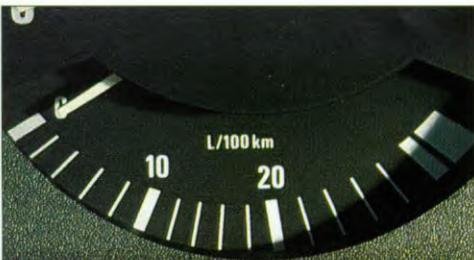
Verbrauchskontrolle. Durch die innovative, elektronische Kraftstoffeinspritzung ist es bei diesem Diesel zum ersten Mal möglich, den momentanen Verbrauch im Cockpit zu kontrollieren.
