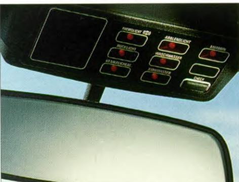
**Permanente Überprüfung.** Die serienmäßige Check-Control überwacht laufend Kühlmittel-, Motoröl-, Wasch- wasserstand und die
