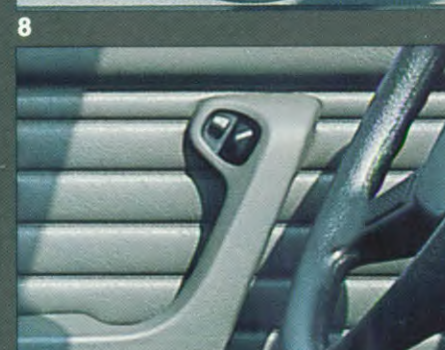
9 De schakelaar voor de elektrisch in te stellen buitenspiegel zit op een zeer handige plaats in de armleuning van de linkerdeur.
