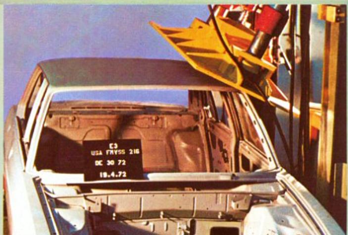
Überprüfung der Dachfestigkeit.
