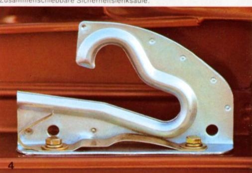
Spezial-Motorhauben-Verriegelung mit Fanghaken.
