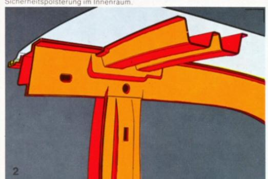
Integrierter Überrollbügel m. längs- und querliegenden Dachversteifungen.
