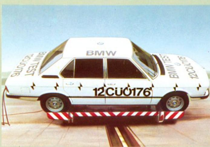
Seitlicher Überschlagversuch zur Stabilitätsprüfung der Sicherheitszelle.
