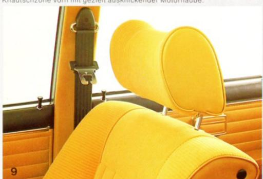
Kombination von Kopfstützen und 3-Punkt-Automatikgurten vorn.
