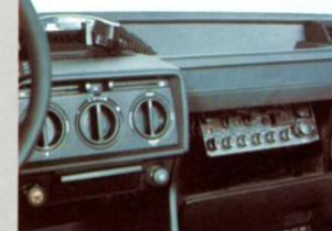
spezielles Ausstattungspaket entwickelt, das dieses wichtige Werkzeug im öffentlichen Einsatz vollständig in das Fahrzeug integriert. Dazu gehören die Karosserievorbereitung, die Halterung für das Funkgerät, das HF-Antennenkabel zur Dachantenne, der Gegensprech-Lautsprecher und eine klappbare Verkleidung für das Funkgerät.
