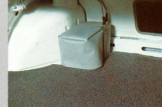
Ob zusätzliche Energie benötigt wird für den Betrieb eines zweiten Funkgerätes, eines EKG-Gerätes oder für Meßgeräte im Dienste des Umweltschutzes oder für die Hilfsleuchten die zusätzliche Energieversorgung durch eine zweite Zusatzbatterie im Gepäckraum ist eine Reserve, die jeden Bedarf decken kann.
