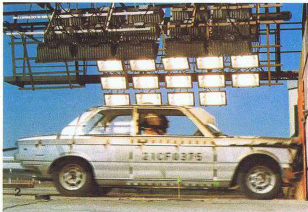
車のフロントとリアーの変形作用を最適化するための衝突テスト。
