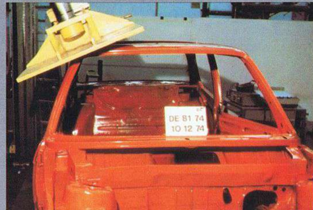
ルーフ・ピラーとロール・オーバーの強度テスト。
