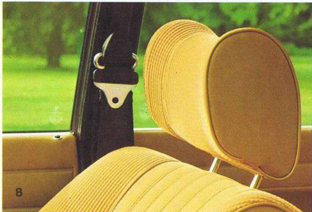
ボタンを押すだけで、高さを調節できるヘッドレストと3点自動安全ベルト。
