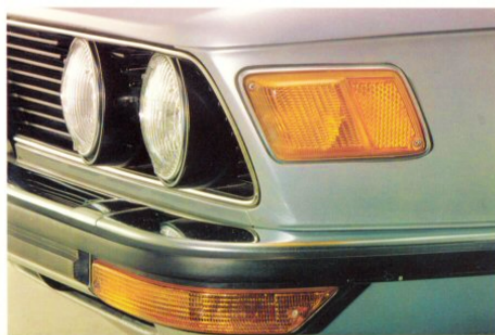
側面に取り付けられた大型フラッシャーランプも安全対策のひとつです。
