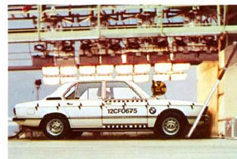
Die Türen bleiben durch die steife Fahrgastzelle und die Sicherheitsverschlüsse auch bei einem Front- oder Heckaufprall geschlossen und lassen sich wieder öffnen (6).
