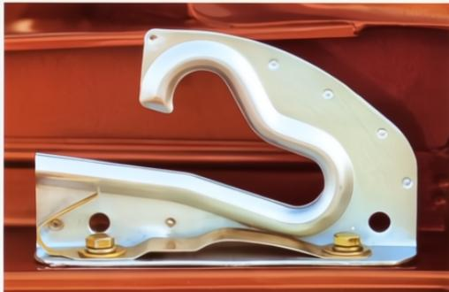
Speciale bloccaggio del cofano motore con ganci d'arresto
