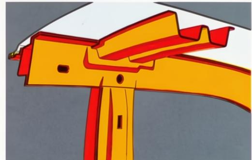
Rollbar incorporato con elementi trasversali e longitudinali per l'ingredimento del tetto
