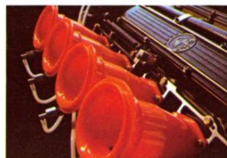
Grazie alla camera di scoppio polisferica di nuova concezione, è stata ottenuta un'ideale turbolenza della miscela e una combustione morbida accompagnata da un elevato rendimento termico. Tutto ciò ha reso possibile uno sviluppo di potenza senza precedenti, una combustione assolutamente silenziosa, dei gas di scarico «puliti» e un consumo di carburante contenuto.
