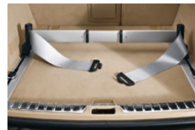
Adaptief bevestigingssysteem, voor het veilig fixeren van bagage in de bagageruimte (leverbaar in combinatie met opbergpakket).
