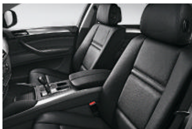
Standaardzetels met handmatige verstelling van zitlengte, zithoek (bestuurderszetel) en hoofdsteun (hoogte en hoek), en elektrisch verstelbare zithoogte en rugleuning. Inclusief actieve hoofdsteunen.
