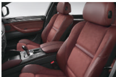
Sportzetels voor bestuurder en voorpassagier. Geprononceerde zijvullingen zorgen voor een optimale zijdelingse steun, onder alle rijomstandigheden. Zithoogte, zithoek en rugleuning zijn elektrisch verstelbaar; de bovenbeensteun is handmatig verstelbaar. Inclusief actieve hoofdsteunen. Memory-functie voor bestuurderszetel, buitenspiegels en elektrisch verstelbare stuurkolom met instaphulp.
