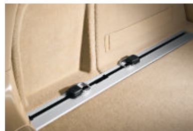
Opbergpakket: omvat onder meer een opbergvak in de middenconsole met 12V-contactdoos en twee fixerrails met vier vergrendelbare bevestigingsogen in de bagageruimtevloer.
