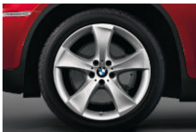
Lichtmetalen BMW wielen in sterspaak styling 259 , met bredere banden achter: vóór 10 J x 20 inch en bandenmaat 275/40 R 20; achter 11 J x 20 inch en bandenmaat 315/35 R 20 (banden met noodloopeigenschappen).
