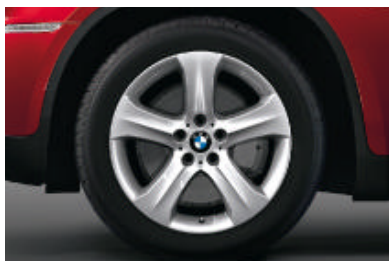
Lichtmetalen BMW wielen in sterspaak styling 258 , met bredere banden achter: vóór 9 J x 19 inch en bandenmaat 255/50 R 19; achter 10 J x 19 inch en bandenmaat 285/45 R 19 (banden met noodloopeigenschappen). Leverbaar in combinatie met het sportpakket.
