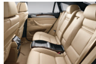
Zetels achterin (twee) , niet verstelbaar, uitgevoerd als individuele, ergonomisch gevormde zetels met middenconsole en geïntegreerde hoofdsteun; inclusief uitklapbare middenarmsteun en twee in de middenconsole geplaatste bekerhouders.
