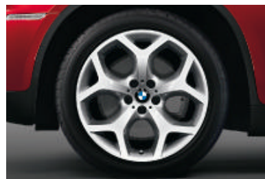
Lichtmetalen BMW wielen in Y-spaak styling 214 , met bredere banden achter: vóór 10 J x 20 inch en bandenmaat 275/40 R 20; achter 11 J x 20 inch en bandenmaat 315/35 R 20 (banden met noodloopeigenschappen).
