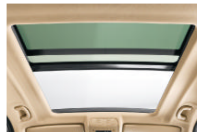
Glazen panoramadak. Met royaal oppervlak en grote opening, voorzien van snelheidsafhankelijke windgeleider. Beide glazen delen hebben een kantelfunctie, elektrisch bediend met tiptoets. Het voorste deel heeft tevens een schuiffunctie. Inclusief elektrisch bediende binnenhemel (zonwering) en comfortopening/-sluiting met inklemb beveiliging.
