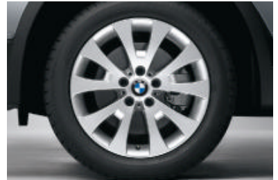
□ BMW Leichtmetallräder V-Speiche 206, mit Mischbereifung, vorn 8 J x 18 Zoll, Bereifung 235/50 R 18, hinten 9 J x 18 Zoll, Bereifung 255/45 R 18.
