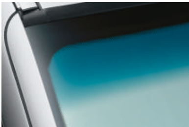
□ Klimakomfort-Frontscheibe reduziert die unangenehme Aufheizung des Innenraums mittels einer Infrarotlicht reflektierenden Schicht; der Grünkeil am oberen Scheibenrand verhindert eine direkte Blendung durch die Sonne.
