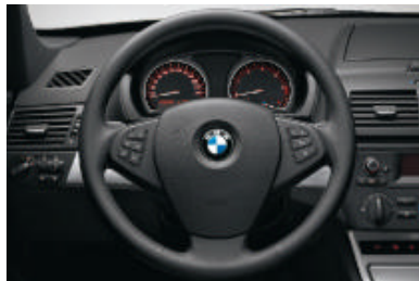
□ Lederlenkrad mit Multifunktion (Serie für X3 xDrive35d) für Geschwindigkeitsregelung und Fernbedienung für Radio bzw. Telefon (optional).
