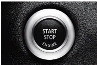
Start-/stopknop. Maakt samen met de afstandsbediening het starten van de motor mogelijk. Eerst wordt de afstandsbediening in de contactschakelaar geschoven. Daarna kunt u uw BMW met een druk op de knop starten of stoppen.
