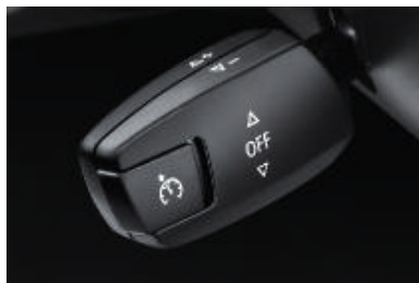
Cruise control: houdt (vanaf circa 30 km/h) een ingestelde snelheid constant aan (bediening via de stuurkolomhendel links). Na een acceleratie-ingreep door de bestuurder wordt de oorspronkelijk ingestelde snelheid automatisch weer aangenomen. Door te remmen wordt de functie uitgeschakeld.
