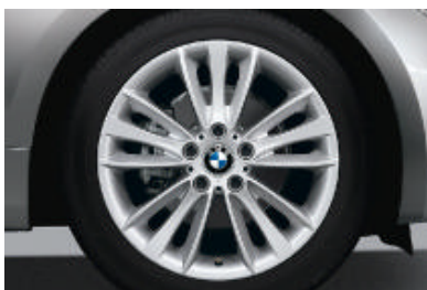
Lichtmetalen BMW wielen in W-spaak styling 263 met noodloopeigenschappen en bredere banden achter: vóór 7,5 J x 18 inch en bandenmaat 215/40 R 18, achter 8,5 J x 18 inch en bandenmaat 245/35 R 18.
