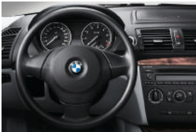
Standaard stuur (diameter 375 mm), driespaaks. Standaard voor 120i, 118d en 120d.
