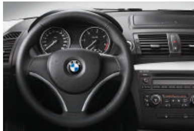
Met leder bekleed sportstuur (diameter 369 mm), driespaaks. Standaard voor 125i, 135i en 123d.
