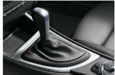
6-traps automatische transmissie Steptronic met adaptieve transmissieregeling (AGS): maakt zeer snelle en harmonieuze schakelgangen mogelijk, voor een optimum aan dynamiek en rijcomfort. Ook leverbaar met schakelpaddles aan het met leder beklede sportstuur of het met leder beklede M sportstuur.
