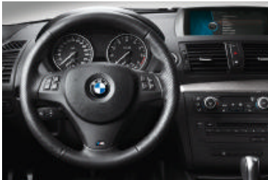
□ M Lederlenkrad (Durchmesser 369 mm), drei Speichen, auf Wunsch mit Multifunktion für Fernbedienung von Radio bzw. Telefon (optional). Wenn Sie sich für das manuelle Getriebe entscheiden, erhalten Sie den M Schaltknopf mit M Emblem. Der Handbremshebelgriff und -balg sind in Leder Walknappa gehalten.
