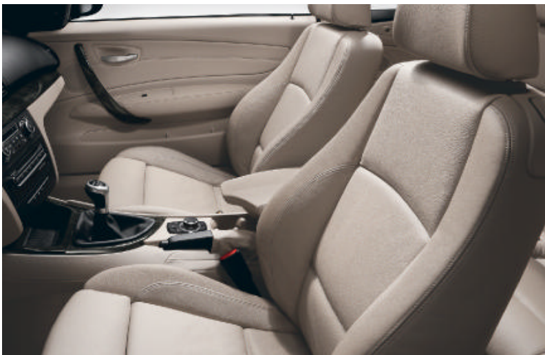
□ Sportsitze für Fahrer und Beifahrer (hier abgebildet mit auf Wunsch erhältlichem Leder Boston in Beige), optimaler Seitenhalt durch stufenlose elektrische Sitzlehnenbreitenverstellung. Sitzlängsverstellung, Sitzhöhe, Lehn- und Sitzneigung sowie Oberschenkelauflage sind manuell verstellbar (Serie für 135i).
