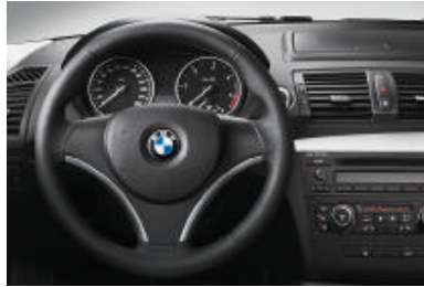
□ Sport-Lederlenkrad (Durchmesser 369 mm), in Verbindung mit Schaltwippen am Lenkrad ohne Daumenauflagen, Chromspange, drei Speichen (Serie für 125i, 135i und 123d).
