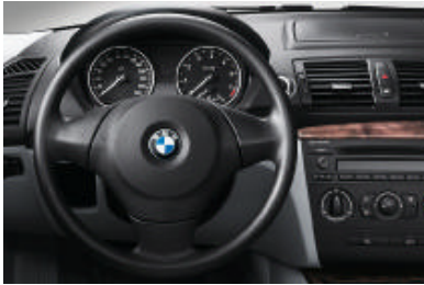
■ Serienlenkrad (Durchmesser 375 mm), drei Speichen.
