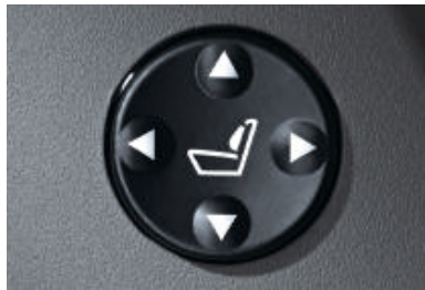
□ Lordosenstütze für Fahrer- und Beifahrersitz, in Höhe und Tiefe elektrisch verstellbar, für eine ergonomisch einwandfreie Sitzposition und zur Unterstützung der Rückenmuskulatur.
