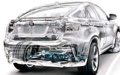
**In einer Rechtskurve kann das linke Hinterrad mehr Kräfte auf die Straße übertragen. Entsprechend verteilt die Dynamic Performance Control mehr Antriebsmoment an das linke Hinterrad.**
