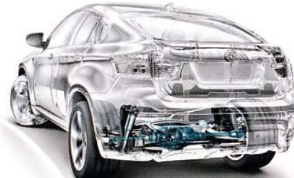
**In einer Linkskurve teilt die Dynamic Performance Control dem rechten Hinterrad mehr Antriebsmoment zu. Denn hier kann das rechte Hinterrad mehr Kraft auf die Fahrbahn übertragen.**
