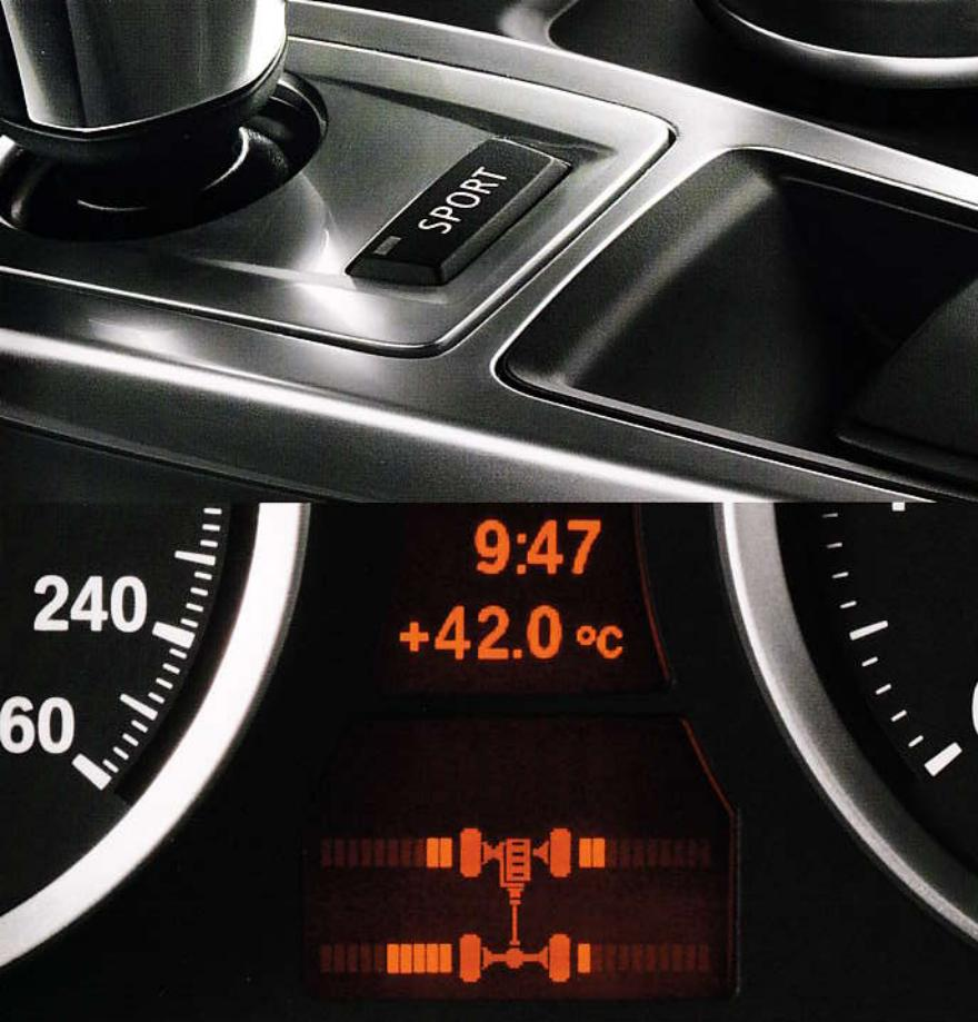
Das auf Wunsch verfügbare aktive Fahrwerksregelsystem **Adaptive Drive** minimiert Wankbewegungen und erhöht die Agilität. Mit dem in dieser Ausstattung enthaltenen **Sporttaster** können Sie eine straffere Fahrwerkseinstellung wählen.
