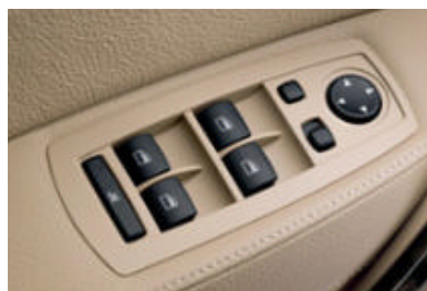
电动车窗升降机 ，包括开启/关闭触控、防夹功能和舒适关闭功能。
