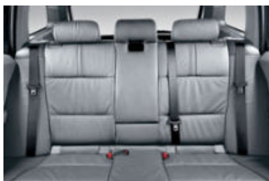
后排安全带系统 ，符合人体工程学，所有座椅都带有三点式安全带及一体式带扣；包括3个头枕(两个外部头枕高度可调)。
