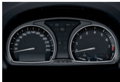
仪表盘，模拟面板，红色背光。车速表中包括液晶显示的里程和行程统计，以及车载电脑，转速表中集成有燃油表和冷却液温度表。
