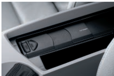
6 碟装 CD 换碟机 ，包括 MP3 解码器，CD 换碟机最多可容纳 6 张 CD，集成在扶手下面。
