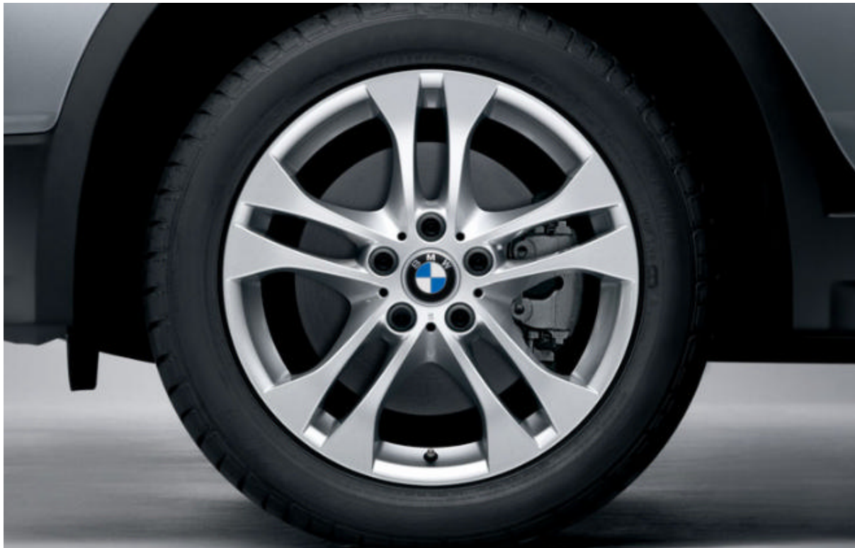
BMW 铝合金轮圈 ，双辐式 205，8 J x 18 英寸，235/50 R 18 轮胎，带锁紧螺母 (3.0si 的标准装备)。
