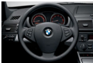
方向盘多功能按钮，用于巡航控制系统和收音机及电话的遥控。三辐式真皮方向盘，上图所示。
