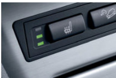
前排座椅加热功能 ；座椅和靠背，包括侧面支撑，确保起动车辆后不久座椅表面散发出宜人的温热。
