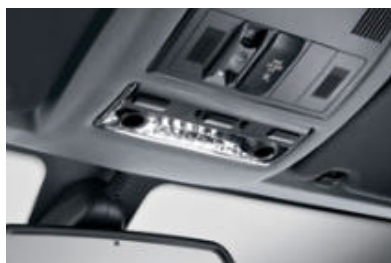
车内照明 ，带自动功能。打开或关闭车门时的渐明 / 渐暗功能；由上而下的中央控制台照明，及前后排阅读灯；前排脚坑照明和化妆镜照明。
