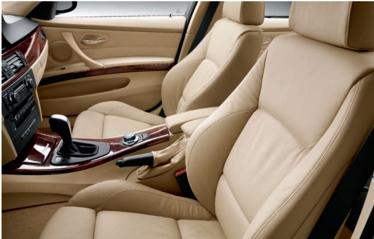
前排标准座椅 (图示带选装的 Walknappa 真皮)，部分电动可调。座椅高度和靠背电动可调，前后位置手动可调，驾驶者侧的倾斜度手动调节。
