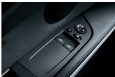
前车门电动车窗升降机，含拉/按开关及触控、便于道口付费的自动升/降功能、全关闭功能和防夹功能。
