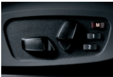
前排座椅电动调节 ，座椅高度、靠背、前后位置和座椅角度电动调节，以及驾驶者座椅和外部后视镜的记忆功能 (包括自动对准路沿)。可以为驾驶者座椅和外部后视镜储存两组个人设置。
