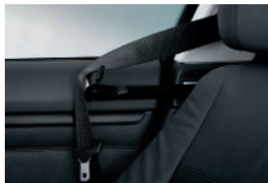
驾驶者和乘客的安全带自动递送器 令安全带的使用更为方便，而且不受座椅位置和靠背角度的影响。乘客侧的座椅乘坐传感器只有在座椅有人使用时才会启动安全带自动递送器。
