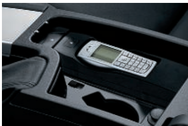
蓝牙电话预留设施，含充电和免提系统以及车外天线连接。使用插入式适配器（选择装备）连接蓝牙兼容移动电话，并通过 iDrive 操作（配备 BMW 专业导航系统）。关于推荐的移动电话型号的信息，敬请垂询 BMW 代理商。
