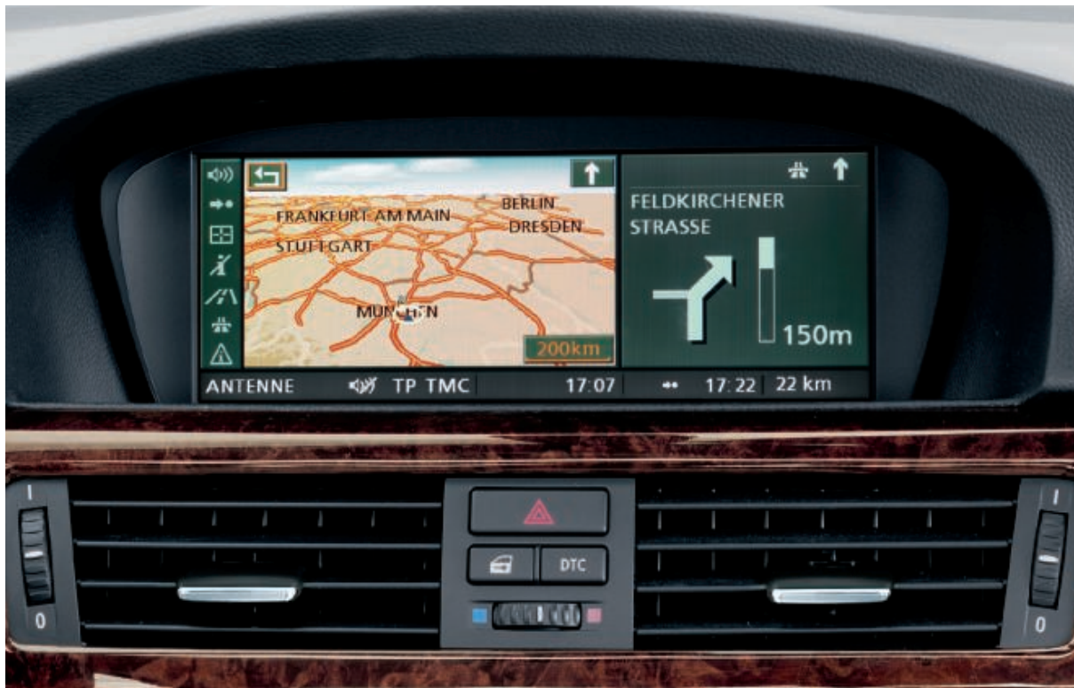
BMW 专业导航系统 ，装备同商用导航系统；加上 CD 光盘驱动器和带三维地图显示的 8.8 英寸显示屏 (图示)。
