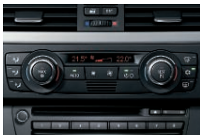
自动空调 ，带微尘过滤器、自动空气再循环 (AAR)、阳光和雾气传感器以及余热按钮，可以使车内迅速达到理想温度并持续保持该温度。还有前排左右两侧温度独立调节、中央控制台内的温控储物盒，以及后排通风和空调。
