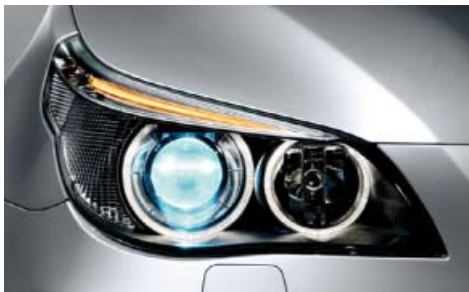
远、近光氙气前灯，含大灯照明高度动态调节。 随动控制大灯改善了转弯时的能见度：这种可调的大灯在车辆开始转弯时就对准了前方的弯道。
