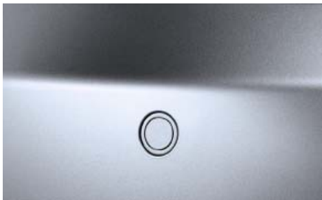
驻车距离报警器 (PDC)，驻车和机动性操纵更加容易，特别是在有限的空间里：车辆和障碍物之间的距离会通过声响警告给出提示，并且控制显示屏上也会出现相应显示。
