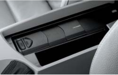
CD换碟机 ，集成在扶手下方。包括可容纳三张CD光盘的储物箱。这个CD换碟机最多可容纳六张CD光盘。
