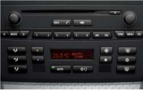
自动空调 ，带有AAR (自动空气室内循环) 和阳光传感器，可以快速创造理想的气候环境，并保持设定的温度；AAR可以在车外污染物达到一定浓度后启动空气室内循环功能，防止车内污染。
