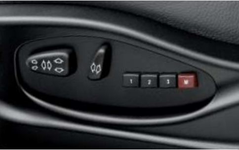
驾驶者和前排乘客的电控座椅调节 ，所有座椅位置都可以电控调节，包括驾驶者座椅和外部后视镜的记忆功能。
