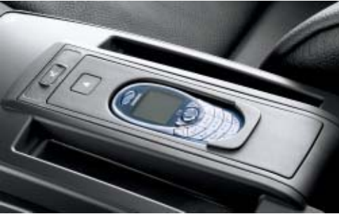
带蓝牙接口的移动电话预留装置 ，含免提装置、充电器连接和天线。插入式适配器 (BMW附件) 连接蓝牙移动电话，蓝牙移动电话可以通过多功能方向盘或导航系统进行操纵。您的BMW经销商将乐于为您提供兼容电话的相关信息。
