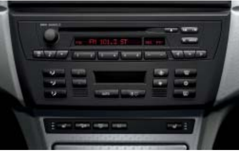
BMW商用级音响设备，附CD播放机 ，4 x 25瓦功率放大器，择优多相式天线，一体式CD光盘驱动器，机动CD光盘插入／弹出，连接BMW CD换碟机及MP3-CD回放功能。
