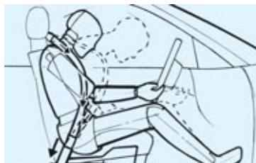
■ **BMW Rückhaltesystem** für Fahrer und Beifahrer, Kombination aus 3-Punkt-Sicherheitsgurt, Gurtstrammer und Gurtkraftbegrenzer sorgt für bestmögliche Rückhaltewirkung bei einer Kollision.
