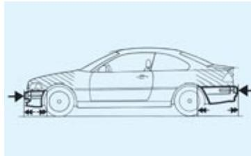
■ **Stoßfänger mit reversiblen Alu-Pralldämpfern** verkraften Stöße bis 4 km/h schadlos; spezielle Verformungszonen vorn und hinten nehmen Kräfte bis 15 km/h auf, ohne die Karosserie zu beschädigen.
