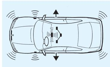
■ **Crash-Sensor** hebt bei einem Unfall die Center-Lock-Funktion der Zentralverriegelung auf (Türen lassen sich öffnen), Innenbeleuchtung schaltet sich ein.
