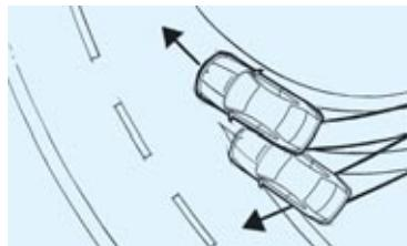
■ **Dynamische Stabilitäts Control (DSC)** inkl. Traktionsmodus: DSC erkennt eine Schleuderneigung schon im Ansatz und stabilisiert das Fahrzeug innerhalb von Millisekunden. Die Unterkunft Traktionsmodus erlaubt bis zu definierten Grenzen einen erhöhten Radschlupf. Für eine sportlichere Fahrweise. Der Traktionsmodus wird durch kurzes Drücken des DSC-Tasters aktiviert.
