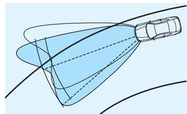
□ **Adaptives Kurvenlicht** leuchtet in die Kurve hinein und sorgt bei Dunkelheit und schlechten Lichtverhältnissen für mehr Fahrsicherheit. Gesteuert wird das System über Sensoren, die Lenkwinkel, Gierrate und Fahrgeschwindigkeit erfassen. Die Scheinwerfer passen sich dann automatisch dem ermittelten Kurvenverlauf an. Aktiviert wird das Adaptive Kurvenlicht über das Lichtschaltzentrum (Fahrlichtautomatik).
