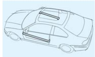
■ **Türverstärkungen:** Diagonal in die Türen eingesetzte Traversen (Verstärkungsprofile) sorgen für eine sehr hohe Türsteifigkeit und bieten bei einem seitlichen Crash höchstmöglichen Insassenschutz.
