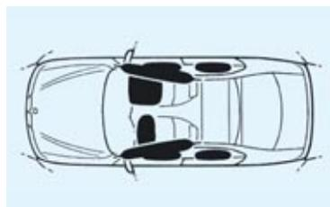
**Airbags:** In einem BMW sind alle Sicherheitskomponenten optimal aufeinander abgestimmt. So wird bei einer Kollision z. B. nur der Airbag, der auch benötigt wird, ausgelöst. Bis zu acht Airbags bieten gezielten Schutz: Fahrer- und Beifahrer-Airbags, die ITS-Kopf-Airbags sowie die Seiten-Airbags vorn und hinten (optional).
