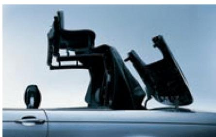
**■ Verdeck**, elektrisch: Die Funktion Öffnen/Schließen des Verdeckes (bei stehendem Fahrzeug) läuft vollautomatisch per Tastendruck im Innenraum oder über das Türschloss ab. Das Öffnen des Verdeckes ist zusätzlich über die Funkfernbedienung möglich.
