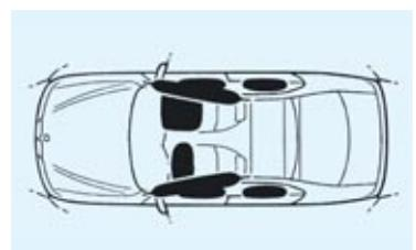
**Airbags:** In einem BMW sind alle Sicherheitskomponenten optimal aufeinander abgestimmt. So wird bei einer Kollision z. B. nur der Airbag, derauf benötigt wird, ausgelöst. Bis zu acht Airbags bieten gezielten Schutz: Fahrer- und Beifahrer-Airbags (die je nach Aufprallschwere unterschiedlich stark auslösen), die ITS-Kopf-Airbags sowie die Seiten-Airbags vorn und hinten (optional).
