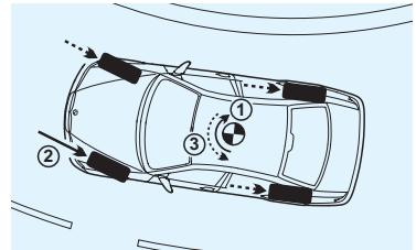
■ **Cornering Brake Control (CBC)** erhöht die Fahrstabilität beim leichten Bremsen in schnell gefahrenen Kurven. Die hinteren Räder werden beim Bremsen entlastet, was in Kurven zum Eindrehen des Fahrzeugs führen kann (1). CBC wirkt dem entgegen, indem es beim Bremsen außerhalb des ABS-Regelbereiches durch asymmetrische Regelung des Bremsdrucks (2) ein stabilisierendes Gegenmoment (3) erzeugt.
