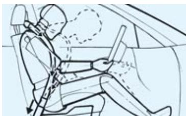
■ **BMW Rückhaltesystem** für Fahrer und Beifahrer, Kombination aus 3-Punkt-Sicherheitsgurt, Gurtstrammer, Gurtkraftbegrenzer und Submarining-Stütze im Sitz, sorgt für bestmögliche Rückhaltwirkung bei einer Kollision.
