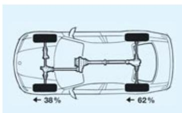
□ **Das Allradsystem**, inkl. Hill Descent Control (HDC) für steile Bergabfahrten, verbindet das hohe Traktionsvermögen eines permanenten Vierradantriebs mit dem hervorragenden Handling eines BMW 3er. Beim Allradantrieb verteilt ADB-X die Antriebskräfte immer optimal auf alle Räder. (Erhältlich für 325i, 330i und 330d.)
