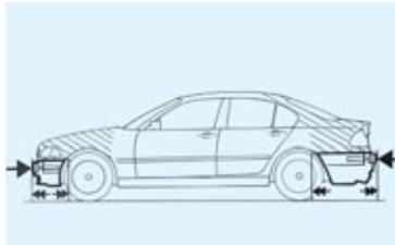
■ **Stoßfänger mit reversiblen Alu-Pralldämpfern** verkräften Stöße bis 4 km/h schadlos; spezielle Verformungszonen vorn und hinten nehmen Kräfte bis 15 km/h auf, ohne die Karosserie zu beschädigen.
