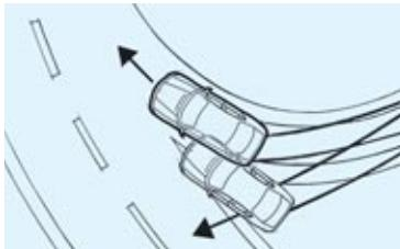
■ **Dynamische Stabilitäts Control (DSC)** inkl. CBC und DBC (Dynamische Bremsen Control): DSC erkennt eine Schleuderneigung im Ansatz und stabilisiert das Fahrzeug innerhalb von Millisekunden. Die Unterfunktion Traktionsmodus erlaubt erhöhten Radschlupf, um situationsabhängig den Vortrieb zu optimieren und sportlicheres Fahren zu ermöglichen.
