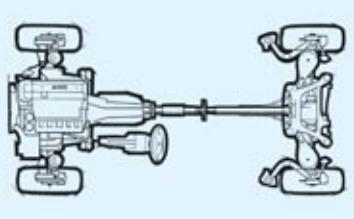
■ **Leichtbaufahrwerk** mit Eingelenk-Federbein-Vorderachse und Zentrallenker-Hinterachse; für hervorragenden Bodenkontakt und höchste Fahrsicherheit bestehen viele Fahrwerksteile aus Aluminium.
