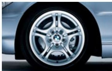
**BMW Leichtmetallräder** Doppelspeiche 68M, mit Mischbereifung, vorn 7,5 J x 17 Zoll, Bereifung 225/45 R 17, hinten 8,5 J x 17 Zoll, Bereifung 245/40 R 17.
