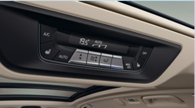
ระบบปรับอากาศอัตโนมัติควบคุมแยกอิสระ 5 โซนสำหรับผู้ขับขี่ ผู้โดยสารด้านหน้า ที่นั่งแถว 2 ทั้งด้านซ้ายและด้านขวา และที่นั่งแถว 3 สามารถตั้งค่าแยกอิสระจากกันได้ เพื่อให้ผู้โดยสารเพลิดเพลินกับบรรยากาศสบายได้อย่างที่ต้องการตลอดการเดินทาง พร้อมฟิลเตอร์อนุภาคนาโนเพื่อให้อากาศที่หมุนเวียนภายในมีคุณภาพและสดชื่นยาวนาน
