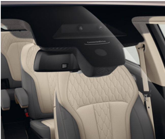
ระบบปรับไฟสูงอัตโนมัติเป็นอุปกรณ์มาตรฐานที่ช่วยอำนวยความสะดวกในการขับขี่ในยามค่ำคืนด้วยการปรับไฟหน้าอัตโนมัติตามรถยนต์ที่ขับสวนทางหรือรถยนต์ที่อยู่ด้านหน้า ระบบจะปิดไฟสูงโดยอัตโนมัติเมื่อสภาพแสงภายนอกเพียงพอ เช่น ในพื้นที่ชุมชน
