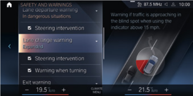
ระบบ Driving Assistant จะแจ้งเตือนพร้อมแทรกการเบรกอัตโนมัติเมื่อจำเป็น ไม่ว่าจะเป็นเพื่อป้องกันการชนด้านหน้าหรือด้านหลังในทางขวางก็ตาม ซึ่งช่วยป้องกันอุบัติเหตุที่อาจเกิดขึ้นขณะเปลี่ยนเลนหรือลงจากรoadได้ นอกจากนี้ ยังสามารถแจ้งเตือนการถูกชนที่อาจเกิดขึ้นจากรถยนต์ที่อยู่ด้านหลังได้ ระบบนี้สามารถลดความเสี่ยงจากการใช้ความเร็วเกินกำหนดได้
