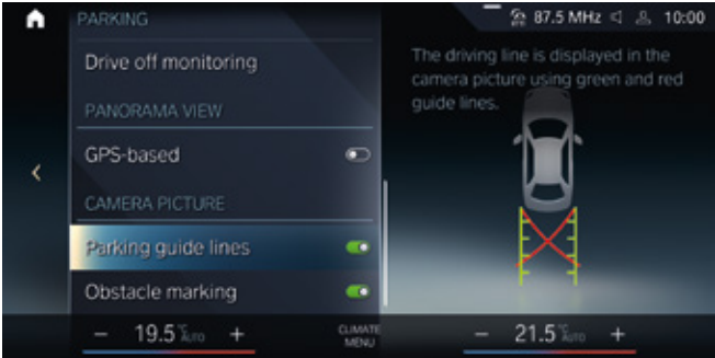
ระบบช่วยนำรถเข้าที่จอดอัตโนมัติ (Parking Assistant) ทำให้การจอดรถเป็นเรื่องง่ายขึ้น ระบบกล้องช่วยถอยรถ Reversing Assist Camera และระบบ Reversing Assistant จะช่วยผู้ขับขี่ถอยรถย้อนกลับในเส้นทางเดิม และป้องกันความเสียหายที่เกิดจากการจอดรถด้วยเซนเซอร์ระบบ Active Park Distance Control โดยระบบ Park Assist ไม่เพียงนำรถเข้าจอดในแนวขนาน หรือแนวตั้งฉากกับถนน แต่ยังช่วยนำรถออกจากช่องจอดโดยอัตโนมัติได้อย่างรวดเร็วและปลอดภัย
