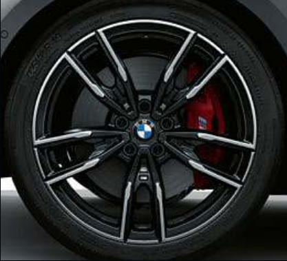
19 吋 M 雙輻式 792 M 型雙色輕合金輪圈，搭配性能胎和前後不同尺寸的輪胎，拋光效果，前輪規格 8J x 19，搭配 225/40 R19 輪胎，後輪規格 8.5J x 19，搭配 255/35 R19 輪胎。
