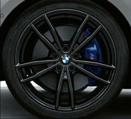
19 吋 M 雙輻式 791 M 型輕合金輪圈，搭配性能胎和前後不同尺寸的輪胎，前輪規格 8J x 19，搭配 225/40 R19 輪胎，後輪規格 8.5J x 19，搭配 255/35 R19 輪胎。
