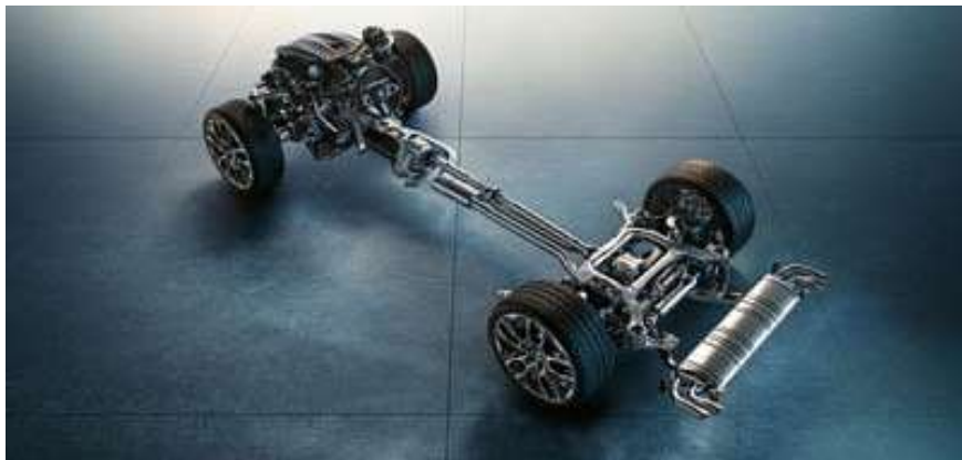
전 모델 기본으로 적용되는 인테그럴 액티브 스티어링은 저속에는 앞바퀴와 반대로, 고속에서는 앞바퀴와 같은 방향으로 조향되어 손쉽고 안정적인 코너링이 가능하여 더욱 안전한 주행이 가능합니다.
