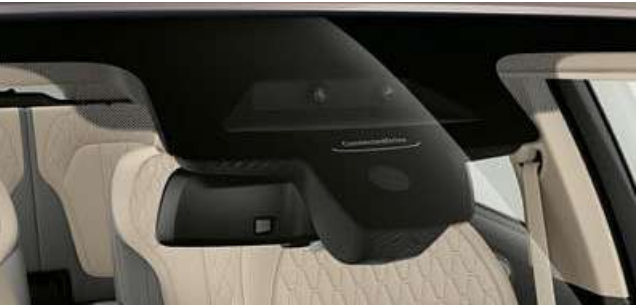
스탠다드 하이빔 어시스턴트 기능이 적용되어 주변 환경에 따라 하이빔이 자동으로 작동하며, 야간 드라이빙 혹은 사고 방지에 특히 유용합니다.
