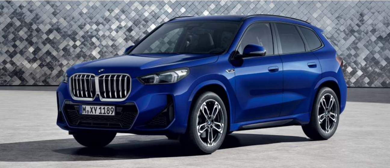
19인치 M 라이트 알로이 더블 스포크 871 M 바이컬러 블랙 그레이 휠, 휠 및 타이어 사이즈 (앞) 8J x 19, 245/45 R19 휠 및 타이어 사이즈 (뒤) 8J x 19, 245/45 R19.
