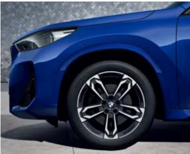
19인치 M 라이트 알로이 더블 스포크 871 M 바이컬러 블랙 그레이 휠, 휠 및 타이어 사이즈 (앞) 8J x 19, 245/45 R19 휠 및 타이어 사이즈 (뒤) 8J x 19, 245/45 R19.
