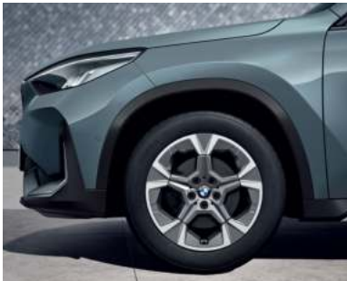
18인치 에어로다이너믹 866 바이컬러 라이트 그레이 휠, 휠 및 타이어 사이즈 (앞) 7.5J x 18, 225/55 R18 휠 및 타이어 사이즈 (뒤) 7.5J x 18, 225/55 R18.
