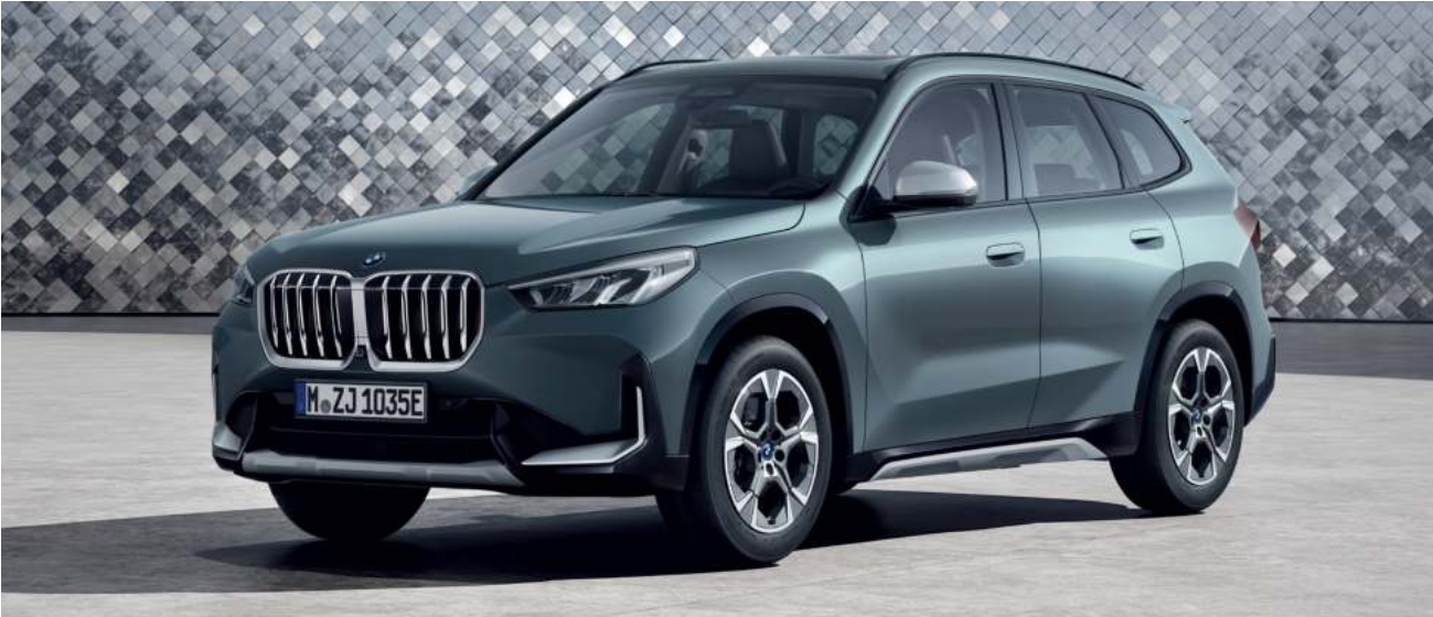
18인치 에어로다이너믹 866 바이컬러 라이트 그레이 휠, 휠 및 타이어 사이즈 (앞) 7.5J x 18, 225/55 R18 휠 및 타이어 사이즈 (뒤) 7.5J x 18, 225/55 R18.
