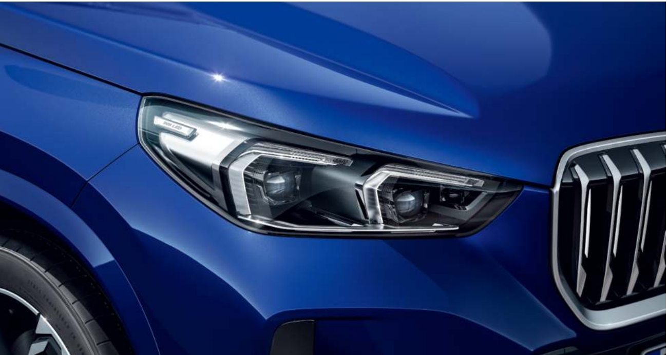
매트릭스 기술이 적용된 어댑티브 LED 헤드라이트는 도로의 상황에 맞게 조절되고 악천후에서 더 나은 가시성을 제공합니다. 최대 시야 범위를 확보하기 위해 헤드라이트는 마주 오는 차량과 전방 차량을 감지하고, 하이빔 헤드라이트의 조사 각을 자동으로 조절하여 맞은편 운전자의 눈부심을 방지합니다.
