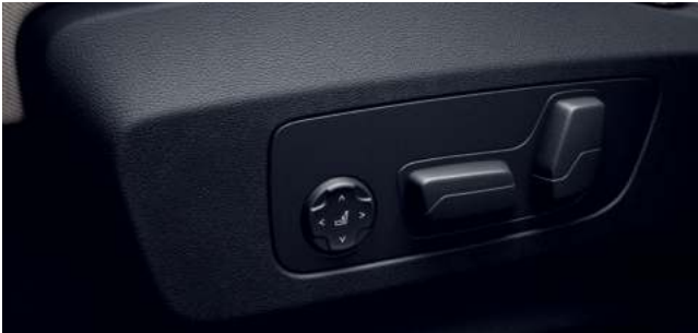
전동식 시트 조절 기능을 사용하면 앞좌석의 시트 높이, 시트 각도, 시트 세로 방향 및 등받이 각도를 쉽게 조정할 수 있습니다. 메모리 기능을 이용해 운전석 시트와 사이드 미러의 설정을 저장할 수 있습니다.
