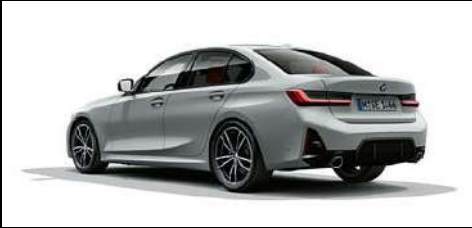
18" M 라이트 알로이 휠 더블 스포크 스타일 848M 바이컬러 제트 블랙, 혼합 타이어, 유광, 휠 크기 프론트 7.5J x 18 225/45 R18 타이어 휠 크기 리어 8.5J x 18 255/40 R18 타이어.
