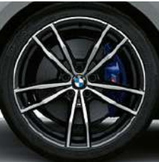
19" M 라이트 알로이 휠 더블 스포크 스타일 791M 바이컬러 제트 블랙, 고성능 타이어 및 혼합 타이어, 유광, 휠 크기 프론트 8J x 19 225/40 R19 타이어 휠 크기 리어 8.5J x 19 255/35 R19 타이어.
