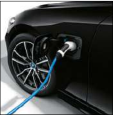
국내 콘센트 표준 충전 케이블(모드 2)을 사용하면 BMW 고전압 배터리를 국내 콘센트로 편리하게 충전 가능합니다.
