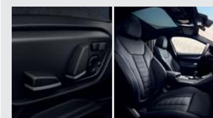
**Le siège avant électrique à mémoire conducteur** permet le réglage électrique de la hauteur du siège, son avance, son inclinaison et celle du dossier avec mémorisation de 2 profils, y compris pour le rétroviseur extérieur conducteur. Le rétroviseur passager comprend l'aide au parking avec activation de la fonction guide-trottoir en marche arrière.
