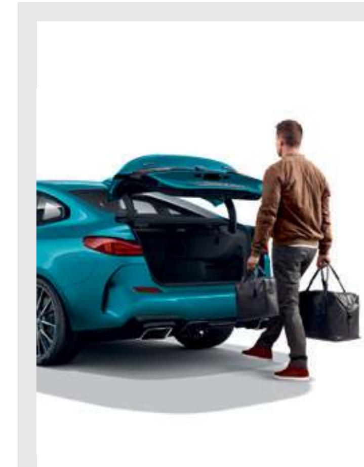
**L'Accès Confort** permet d'ouvrir les portes conducteur et passager et de démarrer le véhicule sur pression d'un bouton sans avoir à sortir la clé de la poche. La fonction "Smart Opener" de l'option Accès Confort permet d'ouvrir le coffre en passant son pied sous le pare-choc.
