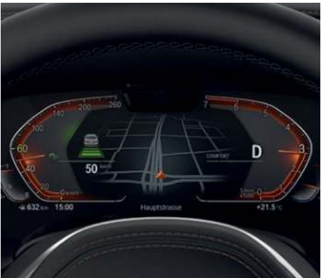
Le régulateur de vitesse actif ACC+ avec fonction Stop&Go régule automatiquement la distance par rapport au véhicule précédent ainsi que la vitesse jusqu’à l’arrêt complet.
