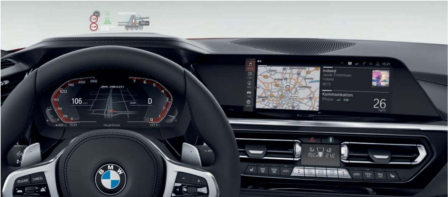
L’Affichage Tête Haute couleur affiche via un système de projection optique les informations importantes pour la conduite dans le champ de vision du conducteur.
