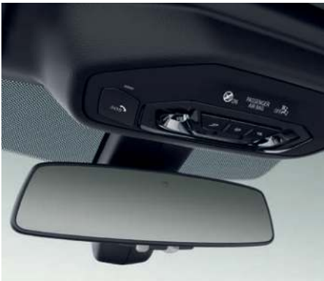
L’alarme antivol avec protection anti-effraction, capteur d’inclinaison, sirène auto-alimentée et système de surveillance de l’habitacle procède à la surveillance des portes, du capot moteur et du volet de coffre.
