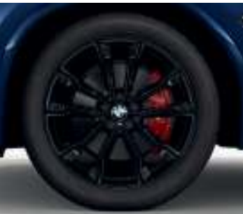
❑ Jantes alliage 20" style 699 M Jetblack à rayons doubles 8 J x 20 / pneus 245/45 R 20 9,5 J x 20 / pneus 275/40 R 20
