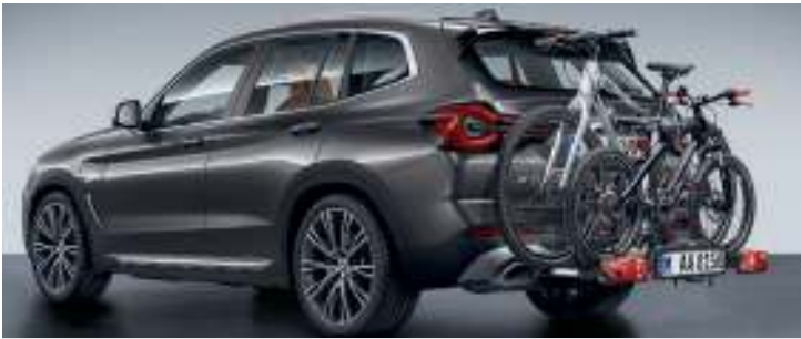
○ Léger et robuste à la fois, le porte-vélos Pro 2.0 supporte jusqu'à 60 kg. Très facile à manipuler, il peut transporter jusqu'à deux vélos/vélos électriques (extensible à trois vélos). Sa fonction de basculement permet l'accès au compartiment à bagages.
