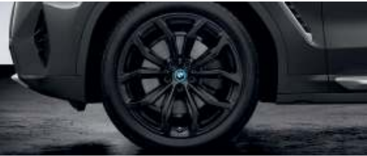
○ Les jantes haut de gamme en alliage léger 20" (51 cm) style 695 à rayons en Y sont en noir mat, avec deux rangées de rayons. Roues complètes été avec monte pneumatique mixte RSC permettant le roulage à plat Dim. : 8J x 20 à l'avant, pneumatiques 245/45 R20 103W XL RSC 9,5J x 20 à l'arrière, pneumatiques 275/40 R20 106W XL RSC Disponibles également en tant que roues complètes hiver.
