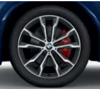
❑ Jantes en alliage 20" style 699 M à rayons doubles avec pneumatiques mixtes 8 J x 20 / pneus 245/45 R 20 9,5 J x 20 / pneus 275/40 R 20
