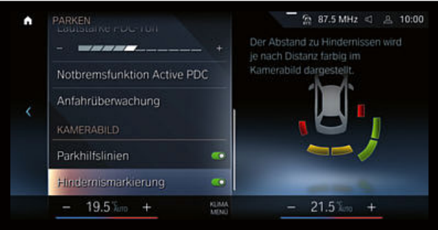
Het assistentiesysteem Parking Assistant Plus 2 vult de Parking Assistant aan met extra camera's en toont de omgeving van de BMW ook driedimensionaal. Zo wordt het behouden van het overzicht bij manoeuvres nog eenvoudiger.
