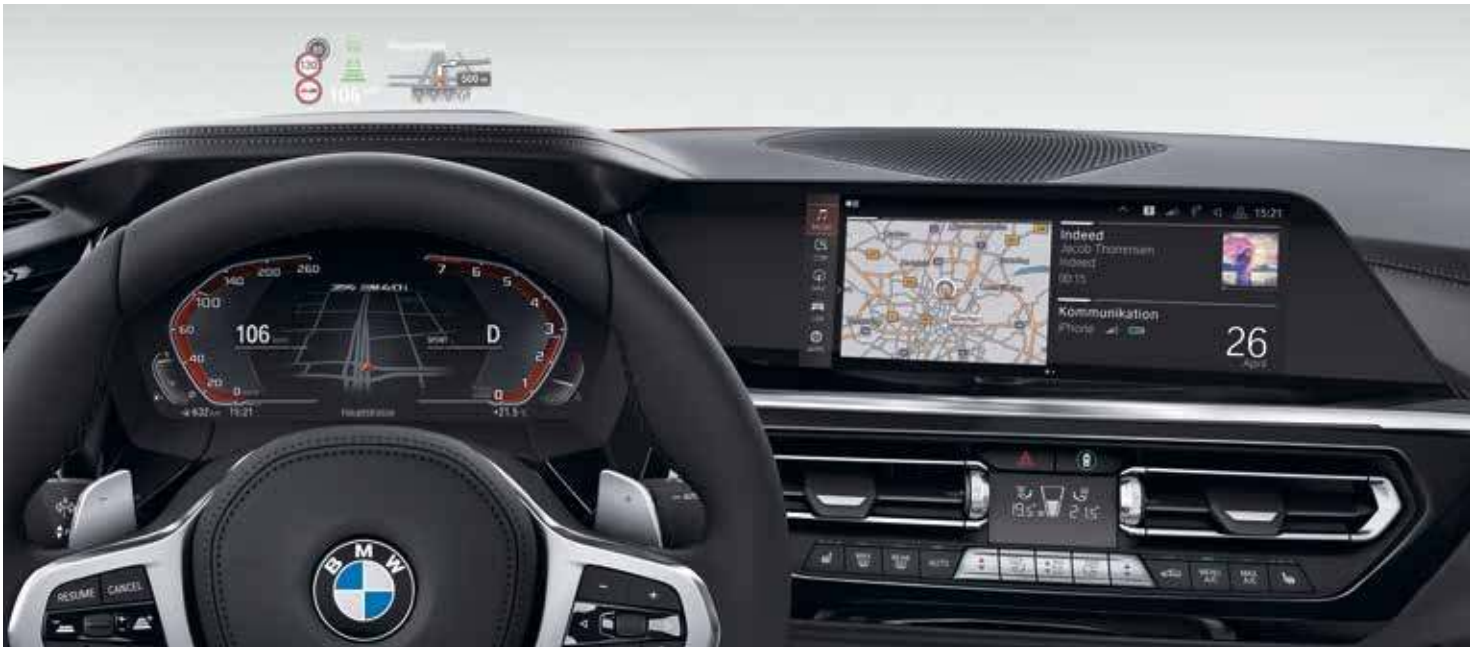
L’Affichage Tête Haute couleur affiche, par le biais d’un système de projection optique, les informations importantes pour la conduite dans le champ de vision du conducteur.
