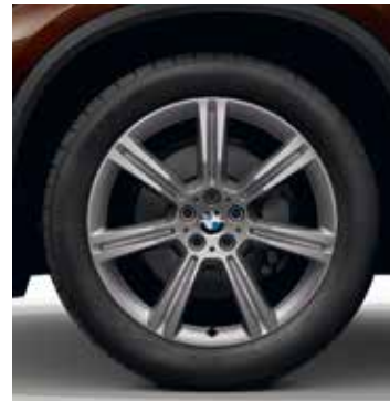
Jantes en alliage léger 20" style 736 à rayons en étoile avec pneumatiques mixtes / RSC 9 J x 20 / pneus 275/45 R 20 10,5 J x 20 / pneus 305/40 R 20
