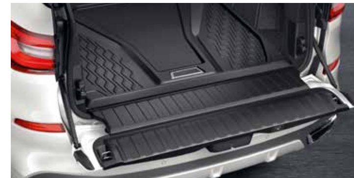
Tapis de coffre en matériau résistant et étanche. Il s'insère parfaitement dans le coffre du véhicule, empêche la charge transportée de glisser et évite les dommages et salissures.
