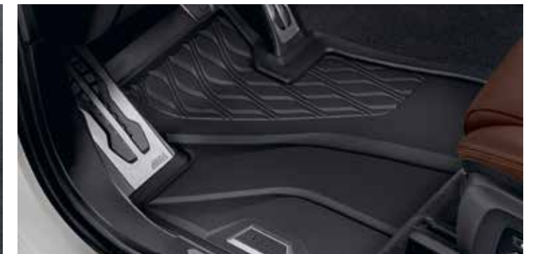
Tapis de sol en élastomère thermoplastique imperméable. Sa forme et son rebord offrent un système de gestion de l'eau pour éviter de salir l'habitacle.
