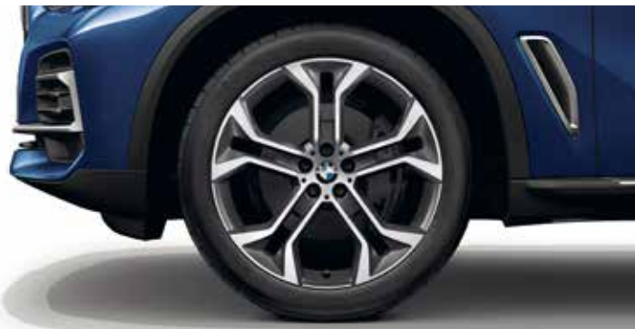
Jantes en alliage léger 21" style 744 à rayons en Y bicolores avec pneumatiques mixtes / RSC 9,5 J x 21 / pneus 275/40 R 21 10,5 J x 21 / pneus 315/35 R 21
