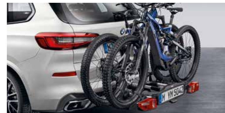
Le porte-vélos facile d'utilisation a été équipé de bras de maintien amovibles, peut accueillir deux vélos ou E-Bikes de série, et convient également au transport de fatbikes avec ses nouvelles courroies dentées extra longues (en option).
