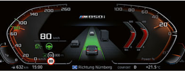
DE SPEED LIMIT ASSIST 1,2 PAST DE ACTIVE CRUISE CONTROL DYNAMISCH AAN DE NADERENDE MAXIMUMSNELHEID AAN.
