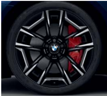
□ Jantes en alliage léger 20" style 1001i 3D BMW Individual aerodynamiques* Pneumatiques avant : 245/35 R20 Pneumatiques arrière : 275/30 R20
