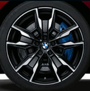
Lichtmetalen M wielen in Dubbel-spaak styling 861 M (achter breder), uitgevoerd in Bicolor Jet Black uni, gepolijst, voor 8,5 J x 19 inch met bandenmaat 245/40 R 19, achter 9 J x 19 inch met bandenmaat 255/40 R 19. 1
