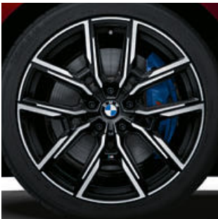
Lichtmetalen M wielen in Y-spaak styling 859 M (achter breder), uitgevoerd in Bicolor Jet Black uni, gepolijst, voor 8,5 J x 19 inch met bandenmaat 245/40 R 19, achter 9 J x 19 inch met bandenmaat 255/40 R 19. 1
