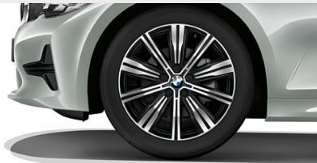
□ Lichtmetalen BMW wielen in Dubbelspaak styling 782, uitgevoerd in Bicolor Jet Black, gepolijst, 7,5 J x 18 inch, bandenmaat 225/45 R 18.
