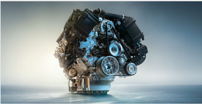
■ Este motor de gasolina de 8 cilindros BMW TwinPower Turbo combina dos turbocompresores, el control de válvulas totalmente variable VALVETRONIC y la inyección directa de gasolina High Precision Injection. Ofrece una potencia máxima de 390 kW (530 CV) y un par máximo de 750 Nm. Los dos turbocompresores están situados de forma compacta entre las bancadas de cilindros.
