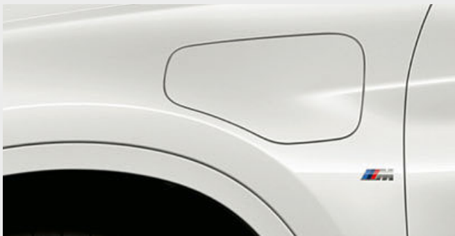
La conexión para recargar desde el exterior la batería de alto voltaje se encuentra tras una tapa situada en la parte delantera del lateral izquierdo del vehículo.
