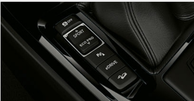
Con el botón de modo de conducción ubicado en la consola central, se pueden seleccionar de manera intuitiva los modos de propulsión AUTO eDrive, MAX eDrive y SAVE BATTERY con solo pulsar un botón, el conductor puede adaptar rápidamente el motor híbrido enchufable a diferentes situaciones de conducción.
